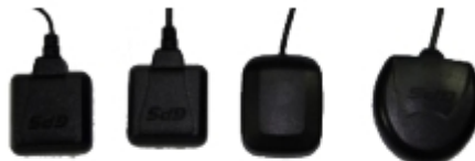
Indoor GNSS Antenna
