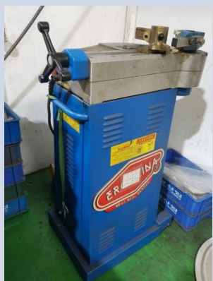
MB42 Max. Radius : 190mm Min. Radius : 2 \times \Phi OD mm Capacity : 25A SCH.80
